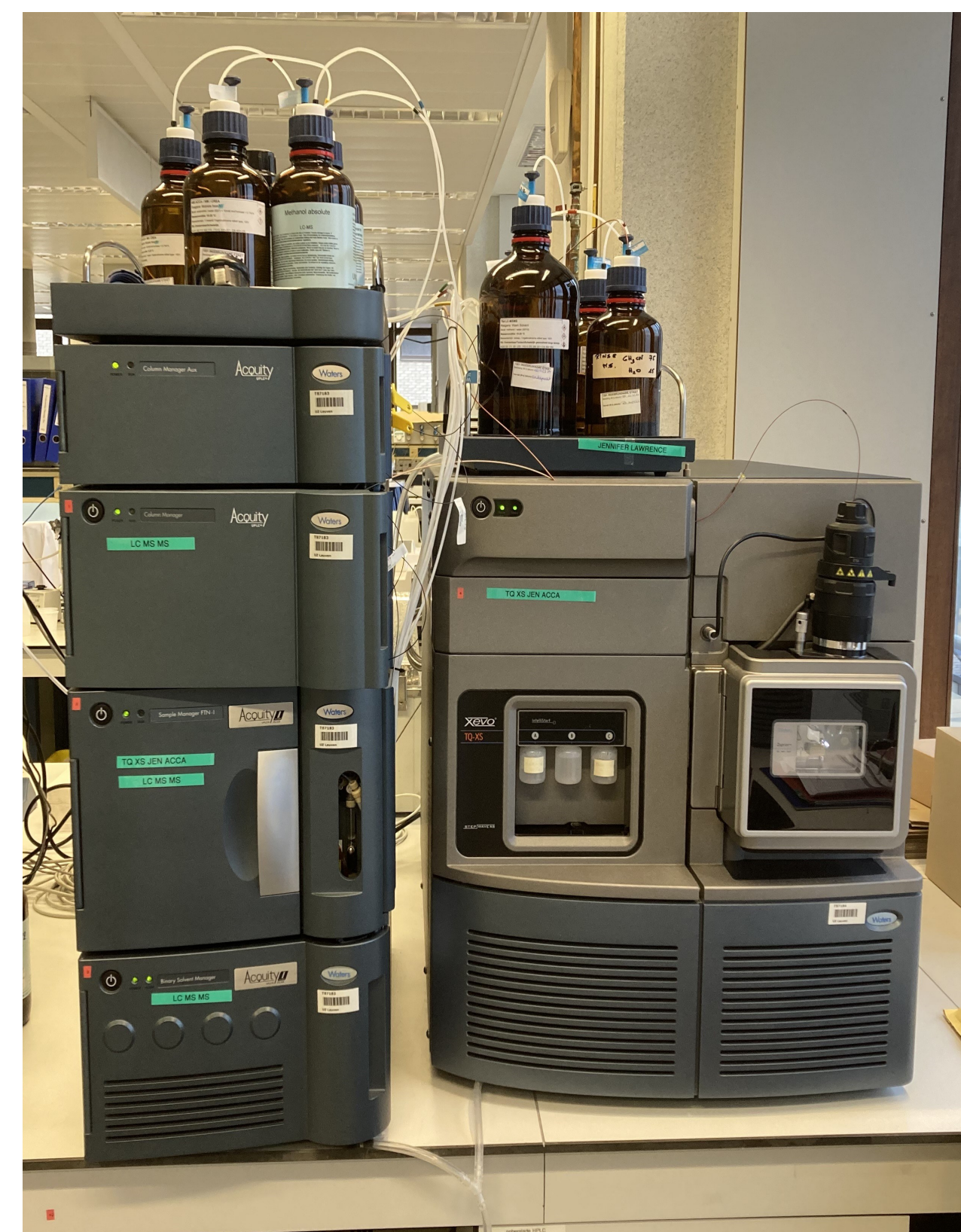
Figuur 1 UPLC MS/MS toestel van Waters, XS model waar de kitmethode op toegepast werd
